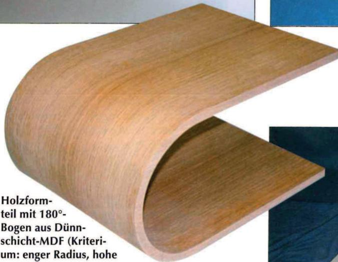
Holzformteil mit 180°-Bogen aus Dünnschicht-MDF (Kriterium: enger Radius, hohe Stabilität)
