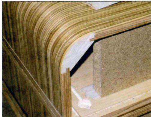
**Starke MDF-Platte als Kern wegen der glatten Oberfläche nach Folienüberzug (Spanplatte wäre hier nicht zu verwenden). Rationelle Fertigung Dank der hohen Kammerausführung an der Tiefziehanlage plus Wärmezufuhr**
