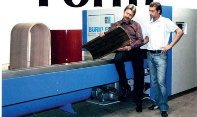
Um noch effizienter und vielseitiger auf Kundenwünsche einzugehen, wurde in diesem Jahr bereits der Zuschnitt durch eine neue liegende Plattensäge optimiert. Weiter können durch die Anschaffung einer Kantenanleimmaschine nun auch ABS-Kanten, sowie Holzkanten bis zu einer Werkstückdicke von 75 mm bearbeitet werden. Ab November steht dem in-
