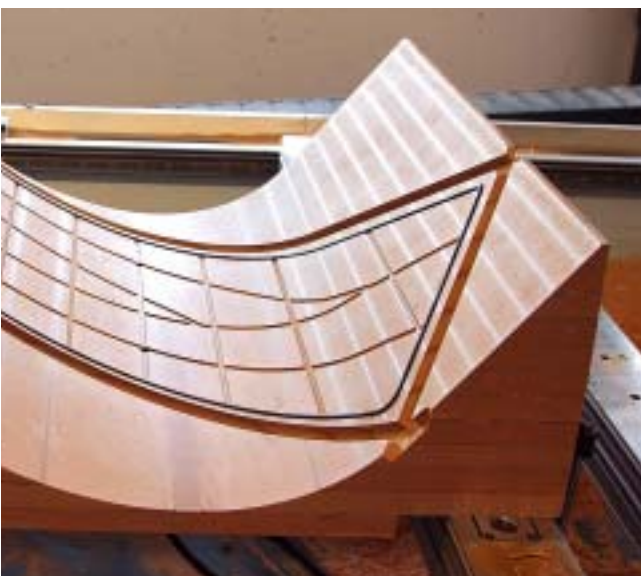
Auch die Spannschablonen produziert das Unternehmen auf der gleichen Maschine selber. Rechts: Ohne CAD/CAM geht bei Ziegler nichts (Fotos: Homag, cn)
