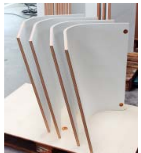
... ist die Schablone so gebaut, dass sie zwischen den Konsolen „unter Null“ geht (Fotos: Homag)
