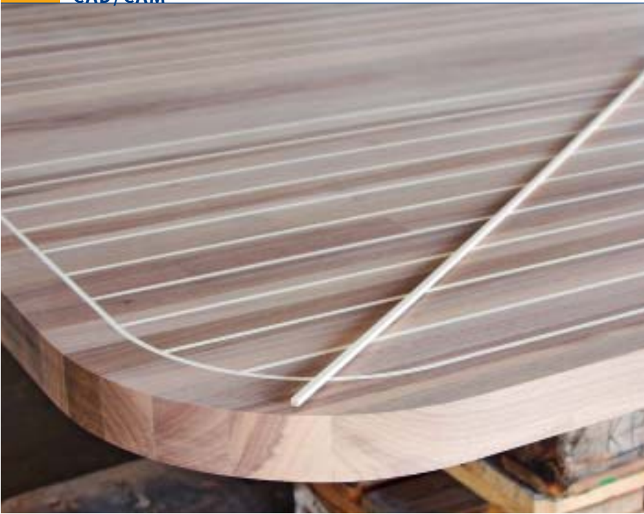
Hohe Präzision ist auch an Deck der „Marecucina“ von Alno Trumpf: In das massive Nussbaumholz fräst Ziegler passgenau die Ahorn-Intarsien ein (Foto: Homag)
