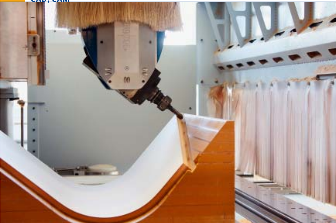
Auf dem 5-Achs-BAZ Homag BOF 311 bearbeitet Ziegler mit hoher Präzision anspruchsvolle Formteile (Foto: Homag)
